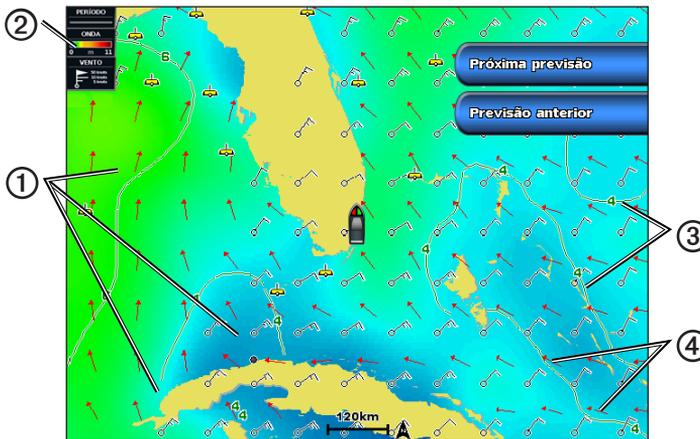
O período de ondulação indica o tempo (em segundos) entre ondulações sucessivas. As linhas de período de ondulação ③ indicam as áreas com período de ondulação idêntico.
