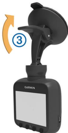
**HINWEIS:** Das Gerät sollte wie dargestellt an der Windschutzscheibe montiert werden. Wird das Gerät seitlich oder verkehrt herum montiert, erfolgt die Videoaufzeichnung seitlich oder verkehrt herum.
