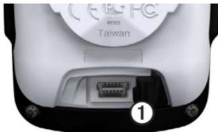
3. Schließen Sie das kleine Ende des Netzteilkabels an den Mini-USB-Anschluss an.
