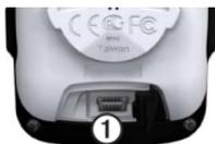
3. Stecken Sie das schmale Ende des USB-Kabels in den Mini-USB-Anschluss.
