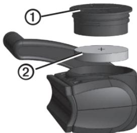
2. Utilisez une pièce de monnaie pour tourner le cache dans le sens inverse des aiguilles d'une montre jusqu'à ce qu'il soit suffisamment desserré pour pouvoir être retiré (flèche pointée sur la position déverrouillée).
