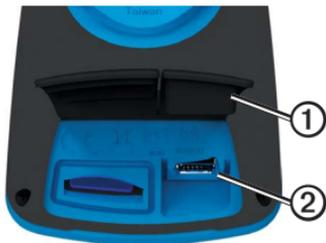
3. Stecken Sie den kleinen USB-Stecker des USB-Kabels in den mini-USB-Anschluss.
