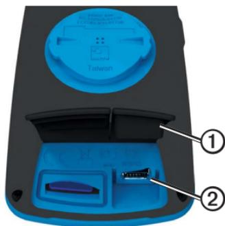
3. Schließen Sie das kleine Ende des Netzteilkabels an den mini-USB-Anschluss an.
