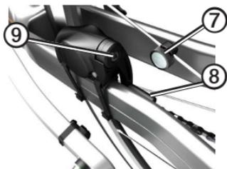
5. Positionieren Sie die Speiche in der Rille des Plastikteils, und ziehen Sie sie leicht fest.
