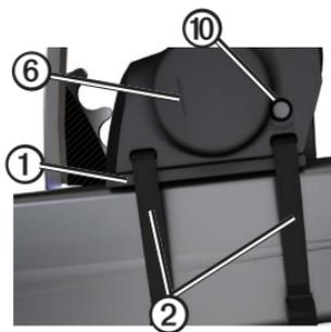
2. Befestigen Sie den GSC 10 locker mithilfe von zwei Kabelbindern ②.
