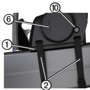
2. Installare il sensore GSC 10 mediante le due fascette ② senza serrarlo.
