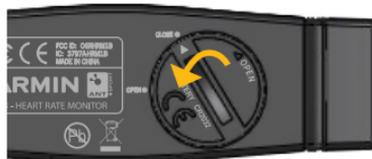
3. Retirez le cache et remplacez la pile en plaçant le pôle positif vers le haut.
