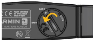
3. Remova a tampa e substitua a pilha, com a face positiva virada para cima.
