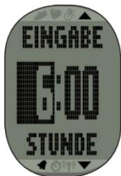
5. Drücken Sie die Taste **ENTER**, um zur Minuteneinstellung zu wechseln.
