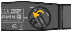
2. Drehen Sie die Abdeckung mit einer Münze gegen den Uhrzeigersinn, bis der Pfeil auf dem Deckel auf **OPEN** zeigt.
