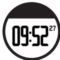
Con la unidad en modo de ahorro de energía, podrá ver la hora, encender la retroiluminación y usar la conexión ANT+™ con su equipo informático. Para salir del modo ahorro de energía, pulse **enter** o **quit**.
