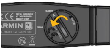
2. Drehen Sie die Abdeckung mit einer Münze gegen den Uhrzeigersinn, bis der Pfeil auf der Abdeckung auf **OPEN** zeigt.
