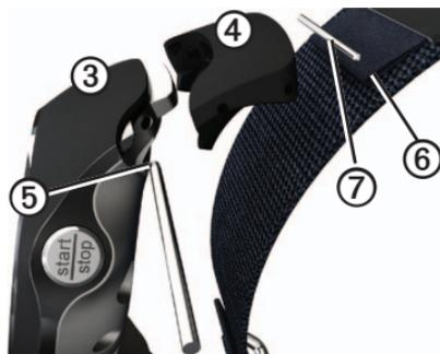
3. Führen Sie das spitz zulaufende Ende ⑤ des Stifts ein, um das Verbindungsstück sicher mit dem Forerunner zu verbinden.
