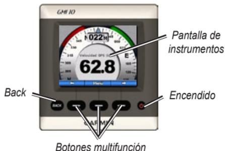
**Encendido:** mantenga pulsado este botón para encender y apagar la unidad. Púlselo y suelte rápidamente para ajustar la configuración de la pantalla
