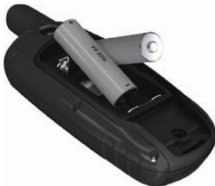
3. Volte a colocar a tampa do compartimento das pilhas.
