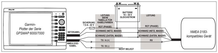
Anschließen zum Senden von Daten an ein NMEA 0183-kompatibles Gerät mit einem Eindraht-TX-Anschluss
