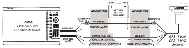
Anschließen an eine Antenne des Typs GPS 17 oder GPS 17 HVS
