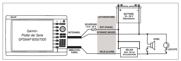
Anschließen an eine Leuchte, ein Horn oder beides
