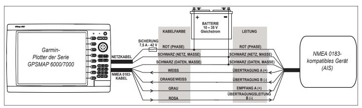
Anschließen an ein NMEA 0183-kompatibles Gerät (AIS)
