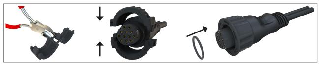
Installieren eines Sicherungsrings
