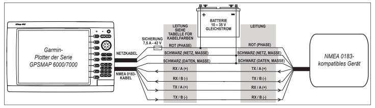
Anschließen an ein NMEA 0183-kompatibles Standardgerät für Zweiwegekommunikation
