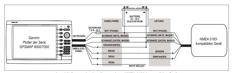
Anschließen an ein einpolig geerdetes NMEA 0183-kompatibles Gerät
