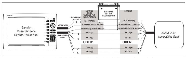
Anschließen an ein NMEA 0183-kompatibles Standardgerät für Einwegekommunikation
