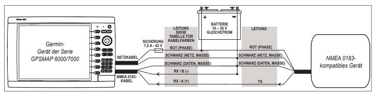
Anschließen zum Empfang von Daten von einem NMEA 0183-kompatiblen Gerät mit einem Eindraht-RX-Anschluss
