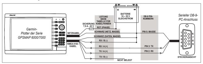
Anschließen an einen seriellen DB-9-PC-Anschluss
