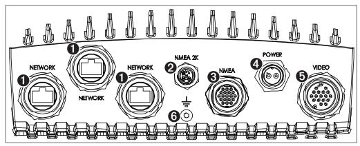
Anschlüsse an den Geräten GPSMAP 6008/6208/6012/6212/7012/7212
