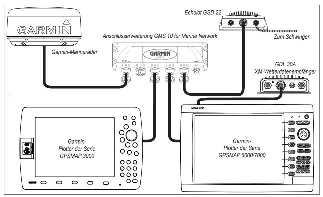
Anschließen eines Plotters der Serie GPSMAP 6000/7000 an ein vorhandenes Garmin Marine Network
