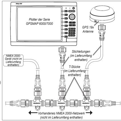
Verbinden eines Plotters der Serie GPSMAP 6000/7000 und einer Antenne GPS 19x mit einem vorhandenen NMEA 2000-Netzwerk
