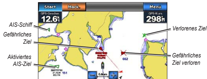
AIS-Zielerfassung auf der Navigationskarte
