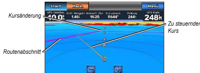
Verfolgen einer Route auf dem Bildschirm „Mariner's Eye 3D“
