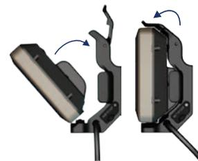
**Colocación de la unidad GPSMAP 620 o GPSMAP 640 en el soporte de montaje**
