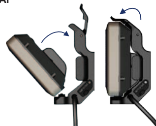
Posizionamento del dispositivo GPSMAP 620 o GPSMAP 640 sulla staffa di montaggio
