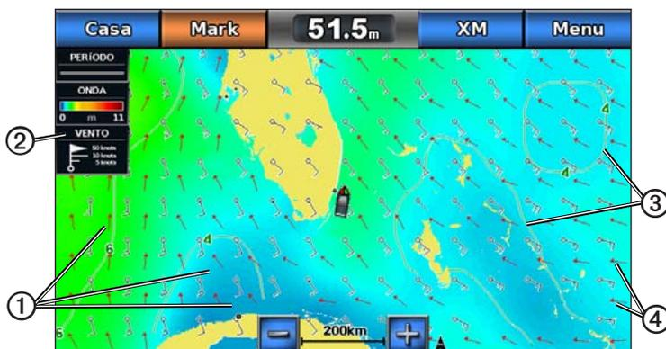
O período de ondulação indica o tempo (em segundos) entre ondulações sucessivas. As linhas de período de ondulação ③ indicam as áreas com período de ondulação idêntico.
