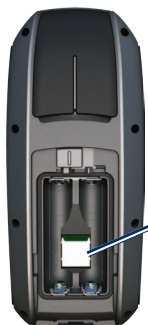
Alloggiamento scheda microSD
