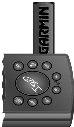
**ALIMENTATION (Symbole de Lampe Rouge)** – Mise en marche/Arrêt de l'appareil. Appuyez brièvement sur cette touche quand l'appareil est en marche pour ouvrir la fenêtre de réglage du rétroéclairage et du contraste. Maintenez la touche enfoncée pour éteindre le GPS V.
