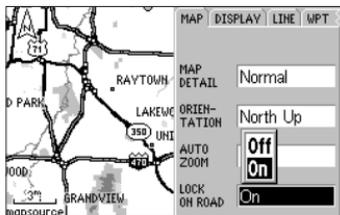
L'option 'Lock On Road' (Verrouillage sur route) 'accroche' le symbole triangulaire de position actuelle sur la route la plus proche. Elle permet de compenser les erreurs minimales d'affichage de position.
