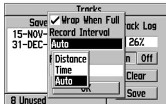
L'enregistrement des journaux de trace s'effectue sur la base d'intervalles de temps, de distance ou d'intervalles automatiques. Le réglage 'Auto' utilise une fonction de résolution dans laquelle aucun point de trace supplémentaire n'est enregistré tant que vous ne déviez pas à gauche ou à droite de la projection de la route.
