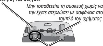
*Μην τοποθετείτε τη συσκευή σε σημείο που ενδέχεται να ανοίξει αερόσακος.*
