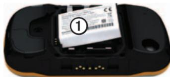
3. Alinea los contactos de metal de la batería con los contactos del compartimento de las pilas/batería.
