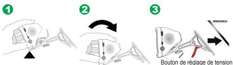
Insérez la base de votre navigateur c320 dans le logement du support à ventouse. Inclinez votre navigateur c320 vers l'arrière jusqu'à ce qu'il s'enclenche. Positionnez la ventouse sur votre pare-brise. Faites basculer le levier vers l'arrière, en direction du pare-brise.
