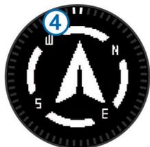
As duas marcas de ponteiro ④ servem como um ponteiro de rumo. A marca na parte superior do dispositivo aponta a direção para a qual está virado.
