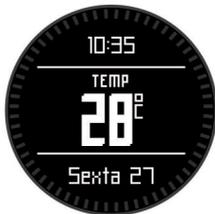
**NOTA:** a sua temperatura corporal afeta o sensor de temperatura. Para obter a leitura de temperatura o mais precisa possível, remova o dispositivo do seu pulso e aguarde entre 20 a 30 minutos.
