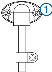
**2** Retirez le passe-fil et, à l'aide d'une mèche de 3,2 mm ( $1/8$  po), percez les trous d'implantation à environ 10 mm ( $3/8$  po) de profondeur.
