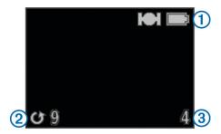
El dispositivo toma fotografías repetidas con el intervalo seleccionado. El visor muestra el estado de GPS y batería ①, el tiempo en segundos hasta que se captura la siguiente foto ② y el número de fotos repetidas que ha capturado el dispositivo ③.
