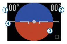
2 Ajusta el dispositivo hasta que el ángulo de balanceo ① y el de inclinación ② sean ambos de 00° y la sección marrón del nivel ③ coincida con la línea del horizonte ④.
