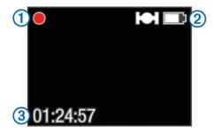
El visor muestra el estado de grabación ①, el estado del GPS y la batería ②, y el tiempo de grabación transcurrido ③.
