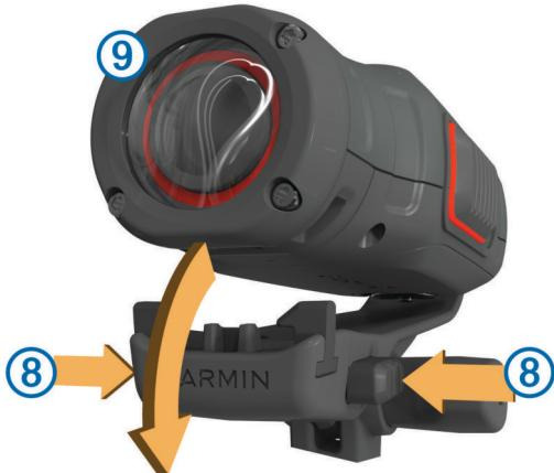
Kameru treba čvrsto držati i nakon pravilnog učvršćivanja ne bi se smjela pomicati u nosaču.
