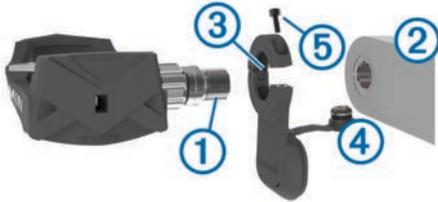
**2** Führen Sie die Pedalachse in die Tretkurbel ② ein.
