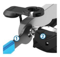
**NOTA:** o eixo e a rosca para o pedal esquerdo têm uma rosca para a esquerda (invertida).
