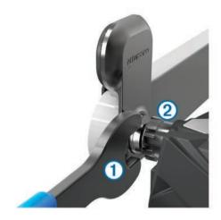
**NOTA:** o eixo e a rosca para o pedal esquerdo têm uma rosca para a esquerda (invertida).
