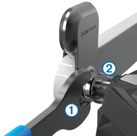
**NOTA:** el eje y la biela del pedal izquierdo tienen una rosca (inversa) para zurdos.
