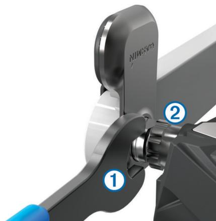
**REMARQUE** : l'axe et la manivelle de la pédale gauche disposent d'un pas de vis à gauche (inversé).
