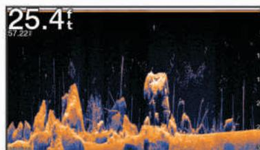
傳統探頭會發射圓錐形聲束。Garmin ClearVü 掃描式聲納技術會發射聲束，類似於影印機中的光束形狀。此聲束提供更清楚、如同圖片般的船下事物影像。
