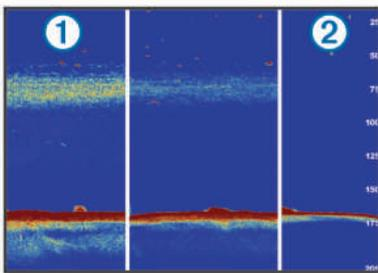
您可以合併使用回音延展和篩選器寬度以獲得較好的解析度，同時降低雜訊。在將回音延展和篩選器寬度皆設為低的情況下，顯示會具有最高解析度，但也最容易受到雜訊影響。在將回音延展設為高而篩選器寬度設為低的情況下，顯示會具有較低解析度，但也具有較寬的目標。在將回音延展和篩選器寬度皆設為高的情況下，顯示會具有最低解析度，但也最不容易受到雜訊影響。不建議將回音延展設為低而篩選器寬度設為高。
