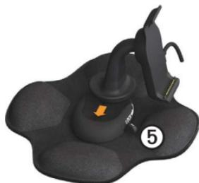
4. Desliza el disco de la parte inferior del brazo en la base hasta que se oiga un clic.
