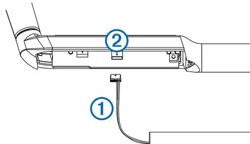
Ce connecteur est doté d'un détrompeur. Ne forcez pas le connecteur lors de son insertion dans le contacteur. Vous risqueriez de l'abîmer.
