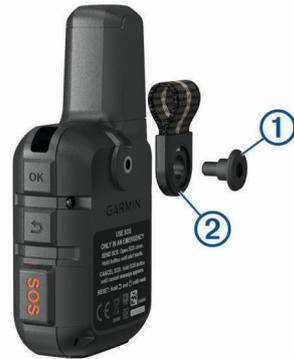
2 Fija el adaptador para montaje en carcasa ① por la parte trasera del dispositivo con el tornillo largo ② incluido con el dispositivo.
