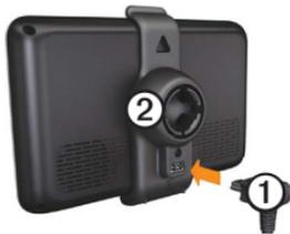
4. Enchufa el otro extremo del cable de alimentación del vehículo a una fuente de alimentación disponible del vehículo.
