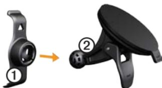
6. Setzen Sie die Unterseite des Geräts in die Halterung ein.
