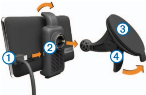
6. Koble den andre enden av strømkabelen til et uttak i kjøretøyet.
