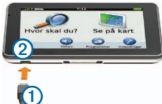
2. Koble USB-kableten ① til USB-porten ② på datamaskinen.
