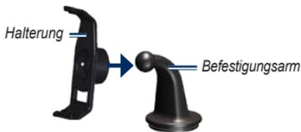
6. Schieben Sie den Befestigungsarm zusammen mit der Halterung auf die Basisplatte.
