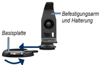
7. Schieben Sie den Verriegelungshebel in die gesperrte Position.
