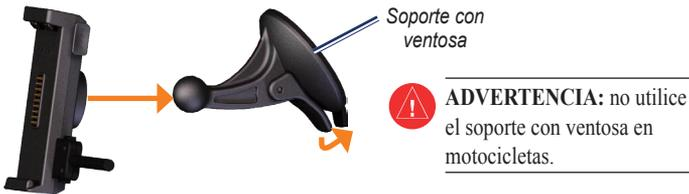
5. Ajuste el soporte de sujeción sobre el brazo de ventosa.
