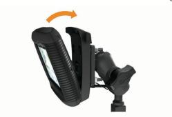
2 Drücken Sie das Gerät zurück, bis es einrastet. HINWEIS: Wenn die Verriegelung oben an der Halterung nach dem Einsetzen des Geräts nicht flach ist, drücken Sie sie nach unten.
