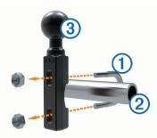
2 Ziehen Sie die Muttern an, damit die Basis sicher befestigt ist.
