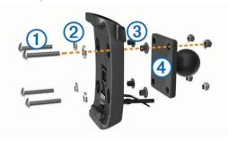
2 Ziehen Sie die Muttern an, sodass die Basisplatte sicher befestigt ist.
