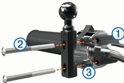
**BEMÆRK:** Både 1/4 tommer tandardbolte og M6-bolte medfølger. Vælg samme størrelse som de fabriksinstallerede bolte på din koblings-/bremsespændbøjle.
