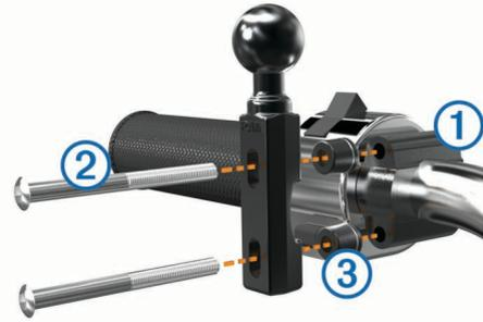
**MERK:** Både 1/4 tommers standardbolter og M6-bolter følger med. Sørg for at fabrikkboltene passer til klemmebraketten for kløtsj eller brems.
