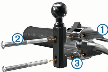
**OPOMBA:** priložena sta 1/4-palčni standardni in M6 vijak. Določite velikost tovarniških vijakov na nosilcu sklopke/zavornega sklopa.
