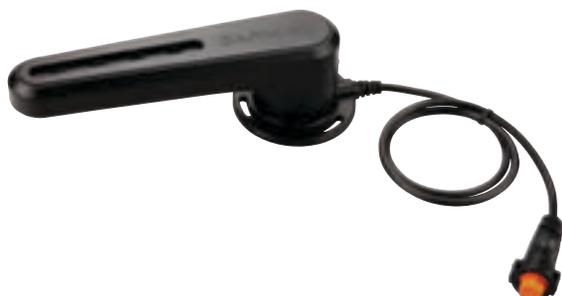
Emparelhe este sensor com o GHP™ 20 ou GHP™ 12 para facilitar feedback da posição do leme, de forma a detetar e a evitar paragens do leme. O GRF 10 utiliza um sensor magnético para transmitir informações sobre a posição, eliminando a fricção que pode causar o desgaste de outros tipos de sensores. O suporte do GRF 10 está ligado ao leme do barco e, através do sensor, e transmite informações sobre a posição ao marinheiro, de forma a este saber onde se encontra o leme.
