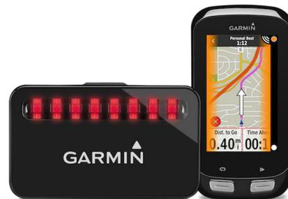
O sistema inclui ainda um transmissor, colocado na luz traseira da bicicleta, e uma unidade com ecrã LED. O transmissor ou sensor deteta, num raio de até 140 metros, a aproximação traseira de veículos e aumenta a intensidade da luz à medida que os carros se aproximam. No modo intermitente, aumenta ainda mais a intensidade da luz.
