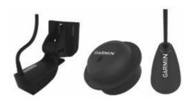
Para instalações no casco da embarcação, o GT15M-IH de 8 pins apresenta-se como um transdutor CHIRP de média banda 85-165kHz, ideal para embarcações em fibra de vidro com um casco com um ângulo de entre 0 e 25 graus preparadas para elevadas velocidades e que necessitam de leituras de profundidade precisas.
