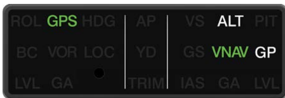
GI 285 Annunciating VNAV/GP Mode
