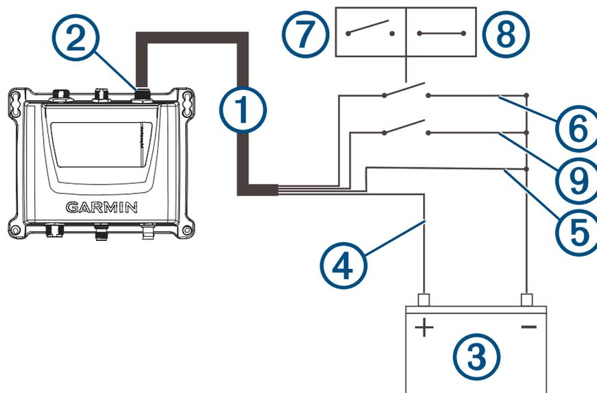
2 Conecta el cable rojo ④ al terminal positivo (+) de la batería.
