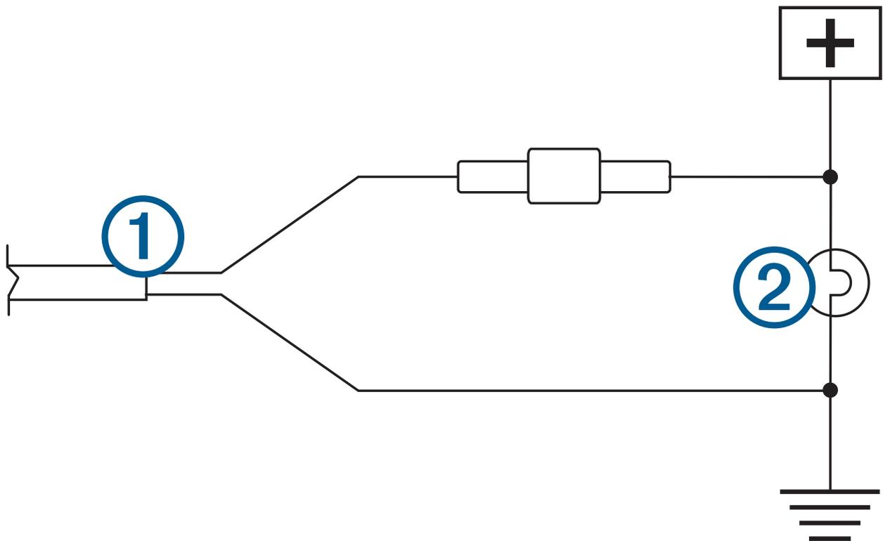
**HINWEIS:** Wenn Sie den Sender mit einer dauerhaft mit Strom versorgten 12- bis 24-Volt-Gleichstromquelle verbinden, z. B. mit einer ständig leuchtenden Lampe, und nicht mit einem Rückfahrlicht, müssen Sie die Stromversorgung des Senders manuell herstellen. Der Sender kann zu einem Entladen der Fahrzeugbatterie führen, falls er nicht ausgeschaltet wird.
