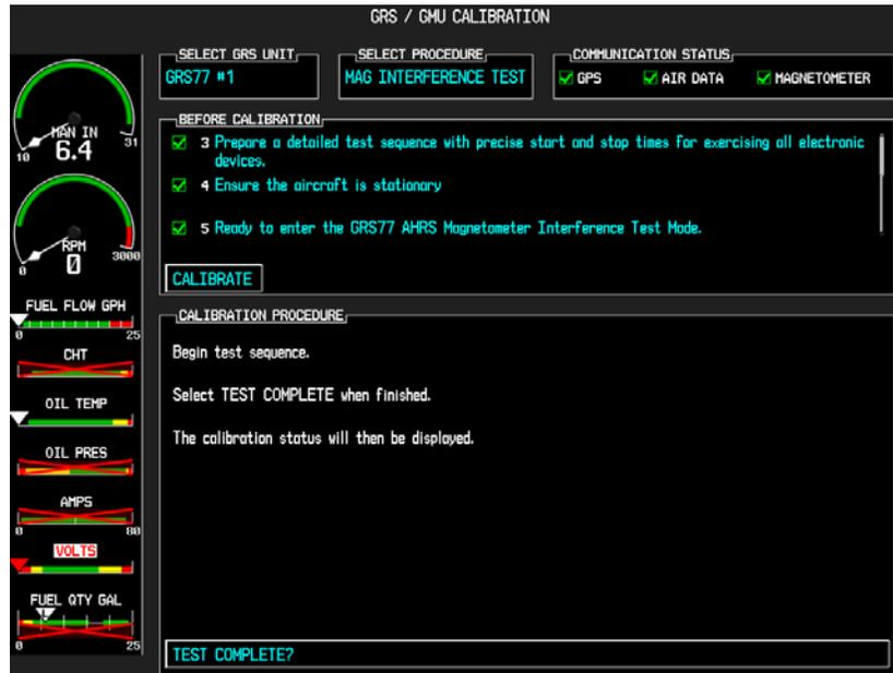
Figure 3-6. Magnetometer Interference Test
